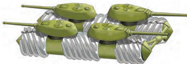
Танк со шнекороторным двигателем (проект не был реализован)
