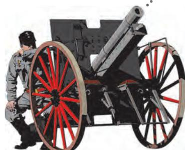
Артиллерийские орудия обычно делят на пушки и гаубицы. Из пушек стреляют по настильной траектории, отлогой, как из стрелкового оружия, а гаубицами — по навесной траектории, вне прямой видимости, по укрытым целям и оборонительным сооружениям.
