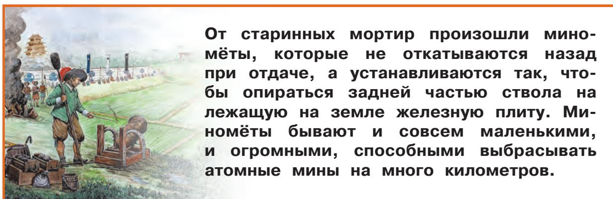
От старинных мортир произошли миномёты, которые не откатываются назад при отдаче, а устанавливаются так, чтобы опираться задней частью ствола на лежащую на земле железную плиту. Миномёты бывают и совсем маленькими, и огромными, способными выбрасывать атомные мины на много километров.
