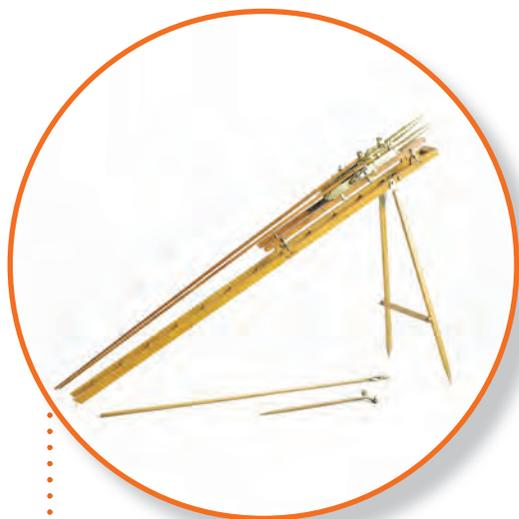
Установка для пуска пороховых боевых ракет, разработанных Уильямом Конгривом и состоявших на вооружении армии Великобритании в первой половине XIX века
