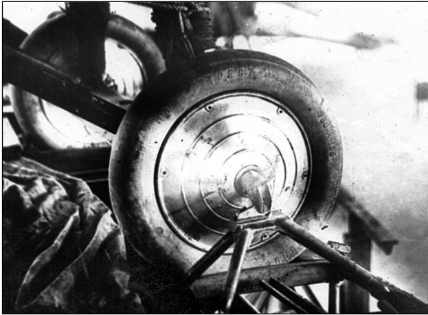
Шасси И-4 закреплено на пирамидах первоначальной конструкции
