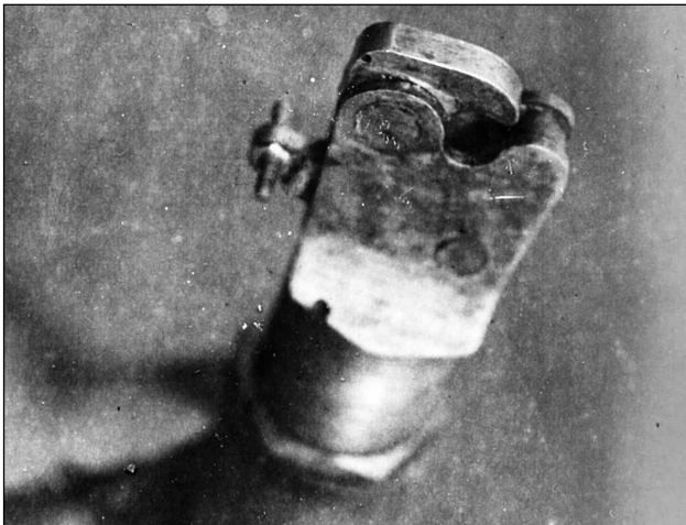
Замок расцепления, установленный на задней, «падающей» пирамиде
