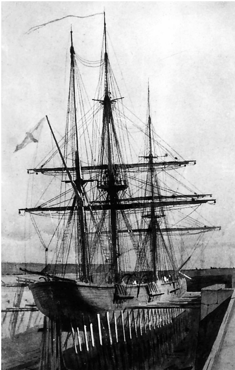
Клипер «Жемчуг» в сухом доке. Видны форма кормовой части корпуса и парусный рангоут
