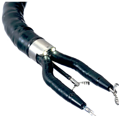
Рис. 5.3. Рабочая часть аппарата для транслюминальной хирургии. В составе рабочей части видеокамера, инструмент для аспирации/ирригации, осветители, два сменных рабочих инструмента
