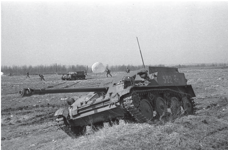
Первой серийно выпускавшейся авиадесантируемой самоходной артиллерийской установкой, созданной для советских ВДВ, стала АСУ-57 (разработана ОКБ-40 под руководством Н.А. Астрова и Д.И. Сазонова на Мытищинском машиностроительном заводе). На фото — АСУ-57 с 57-мм пушкой Ч-51М действует в боевом порядке парашютного десанта
