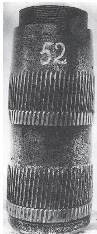
Из истории «нарезных» снарядов. Снаряды германской 21-см сверхдальнобойной пушки «Колоссаль» (1918 г.) имели два ведущих пояска с готовыми нарезками. На фото — снаряд без баллистического колпака
