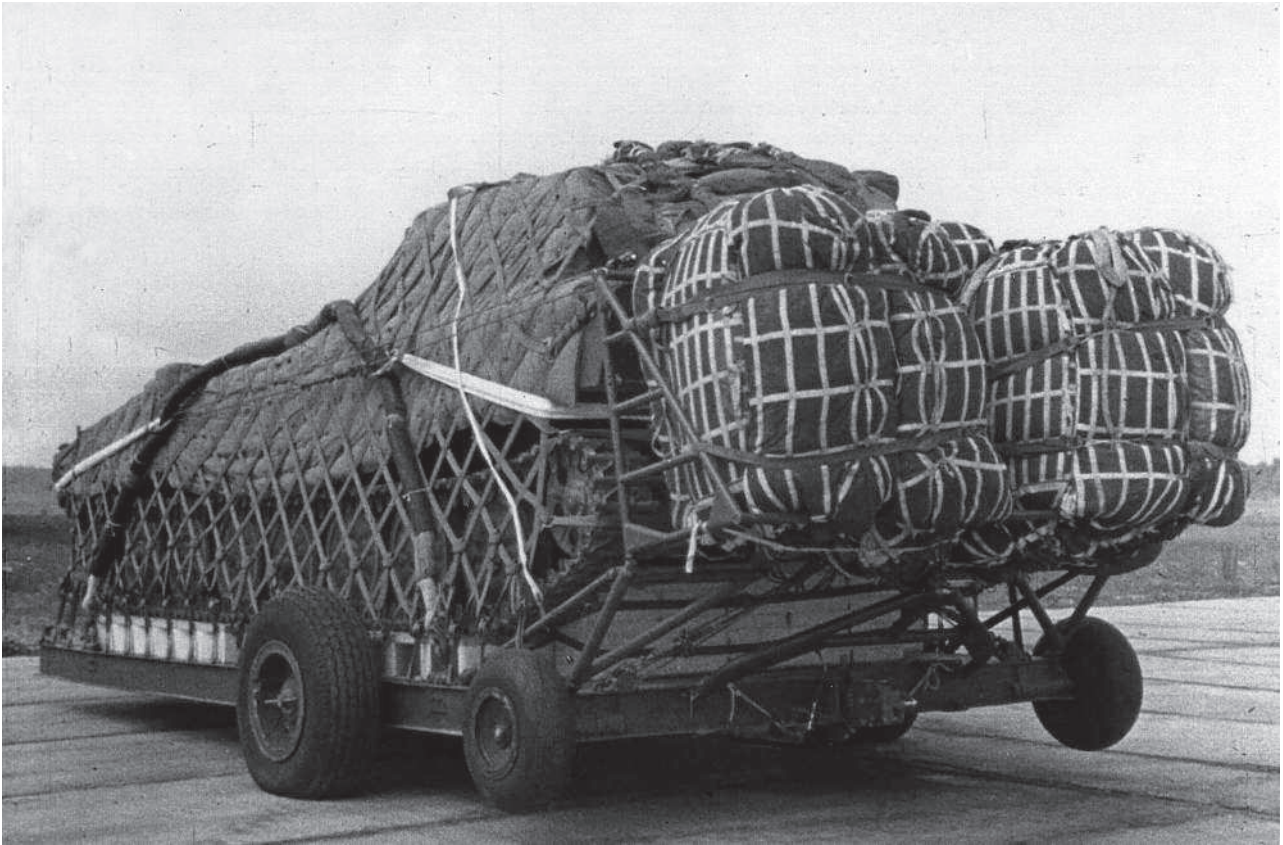
Самоходная 122-мм гаубица 2С1 «Гвоздика» создавалась для Сухопутных войск, однако в интересах ВДВ ставились опыты ее парашютного десантирования. На фото — 2С1 «Гвоздика» подготовлена к десантированию с парашютной десантной платформой П-16М
