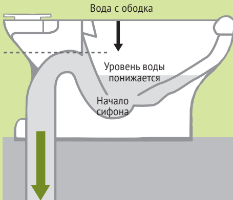
В результате действия сифона произошёл слив воды
