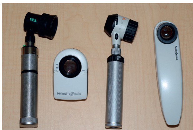
Рис. 2.2. Наиболее часто применяемые неполяризованные контактные дерматоскопы. Слева направо: Episcoper (Welch Allyn; www.welchallyn.com ); DermLite Fluid (3GEN, LLC; www.dermlite.com ); Delta 20 (Heine; www.heine.com ); DermoGenius (Biocam; www.dermogenius.com )
