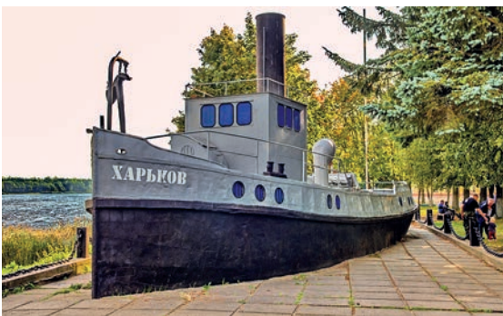
Буксирный пароход «Харьков» участвовал в прокладке кабелей по дну Ладожского озера и перевозках. Рубка и труба из металлических листов — муляжи, рубка была деревянной.
