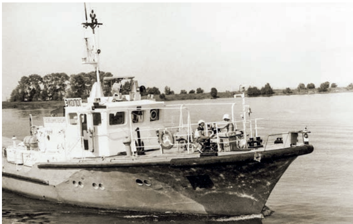
Патрульное судно «Эколог» Северо-Западного территориального управления Госводинспекции — стальной рейдовый лоцманский катер проекта 1459 полным водоизмещением 88,5 тонн. Катер ходит на двух дизелях ЗД12 по 300 лошадиных сил каждый со скоростью до 12 узлов. «Эколог» построили в 1983 году на Ленинградском судостроительном и судоремонтном заводе «Пелла» на Неве.
