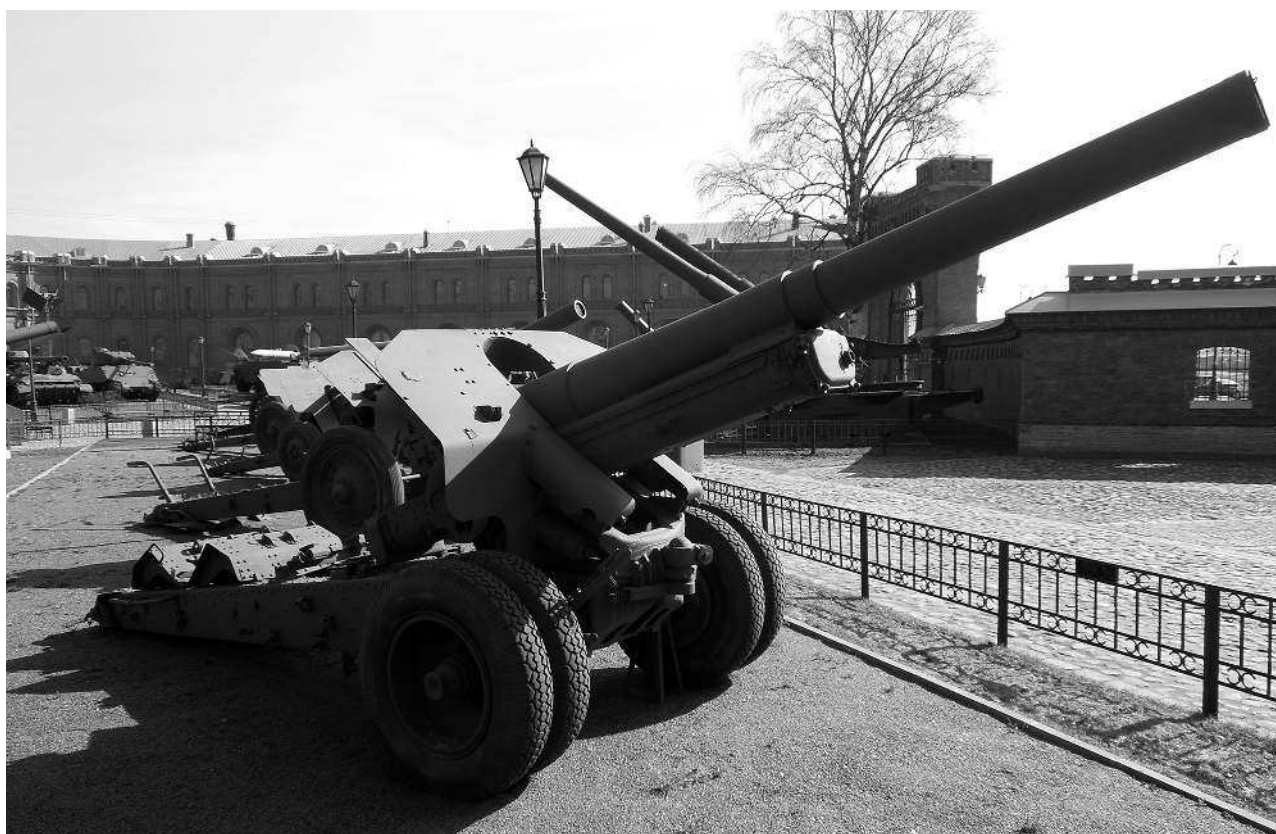
Серийная 152-мм гаубица обр. 1938 г. (М-10) в экспозиции Военно-исторического музея артиллерии, инженерных войск и войск связи, г. Санкт-Петербург. .
