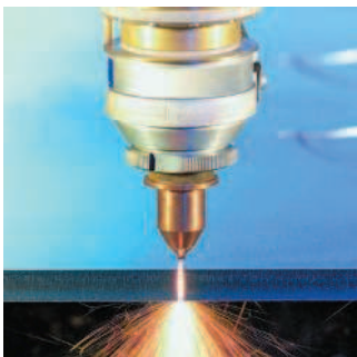
Рис. 1.4. Процесс лазерной резки металлического листа
