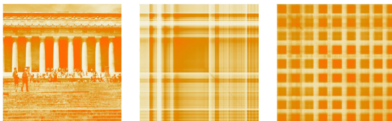
Рис. 8.5. Мемориал Линкольна M (слева) и его ковариационные матрицы. Большой блок в середине MM^T (в центре) является результатом сходства всех рядов от средней полосы M . Рисунок плотной сетки M^T M (справа) отражает регулярный шаблон колонн на здании мемориала
