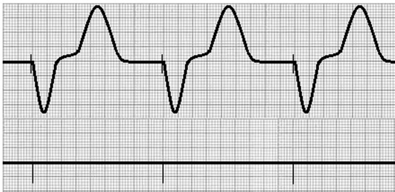
Рис. 35. Работа электрокардиостимулятора в режиме VVI(R) при электрокардиографии
