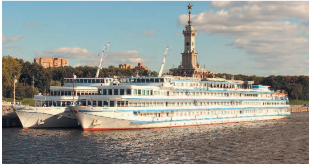
▲ Речные пассажирские суда дальнего плавания у речного вокзала в Москве. Такие похожие друг на друга корабли, построенные в ГДР и Чехословакии в 1960–1980-х гг., до сих пор составляют основу речного круизного флота России и Украины
