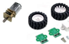
Рис. 1.9. Редукторный мотор с шинами и датчиком угла поворота
