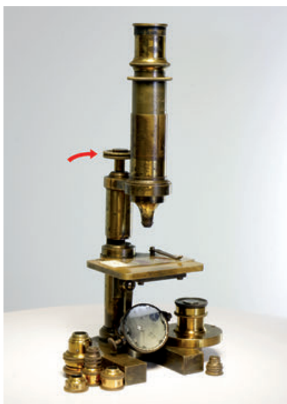
Рис. 1.2. Усовершенствованный микроскоп Е. Гартнака (60—70 гг. XIX в.); стрелкой указан винт, с помощью которого осуществляется тонкая фокусировка; грубая фокусировка достигается непосредственным передвижением тубуса
