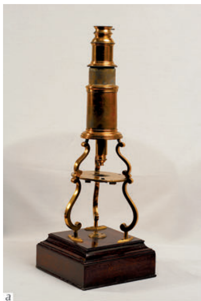
Рис. 1.1. Микроскоп кельпеперовского типа (а); простой микроскоп немецкого оптика Е. Гартнака (30—40 гг. XIX в.) (б)
