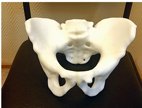
Рис. 1.3. Макет таза, созданный на FDM-3D-принтере
