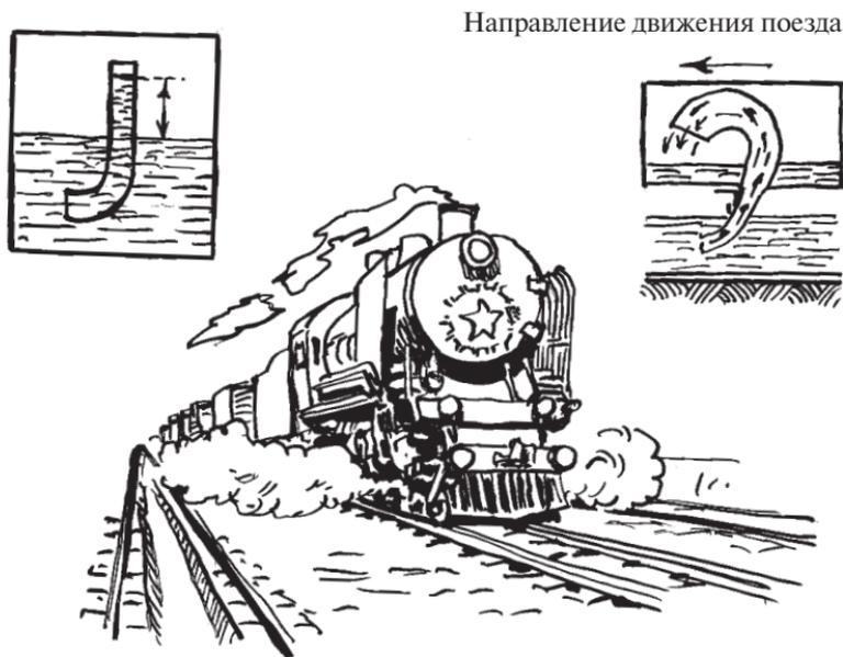
**Рис. 4.** Как паровозы на полном ходу набирают воду. Между рельсами устроен длинный водоем, в который погружается из тендера труба. Вверху налево — трубка Пито. При погружении ее в текущую воду уровень в трубе поднимается выше, чем в водоеме.
