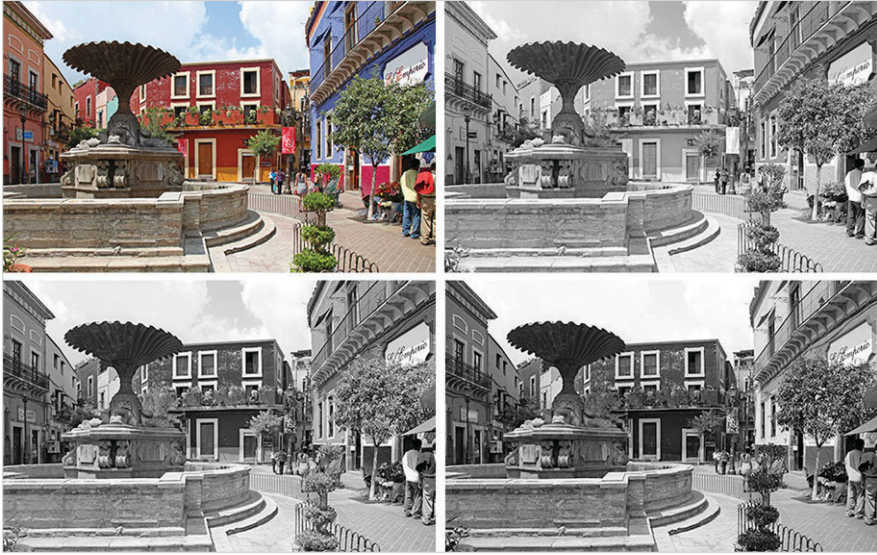
Рис. 1.4. Исходное цветное RGB-изображение Fountain (слева сверху), на котором запечатлена площадь в Гуанахуато, и его разложение на три канала: красный (справа сверху), зеленый (слева снизу) и синий (справа снизу).
