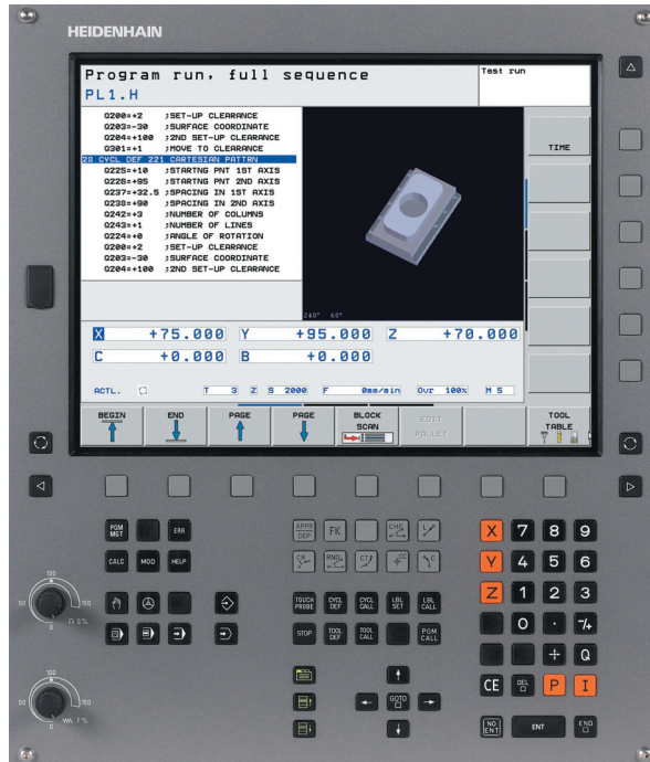
Рис. 1.3. Стойка ЧПУ Heidenhain TNC
