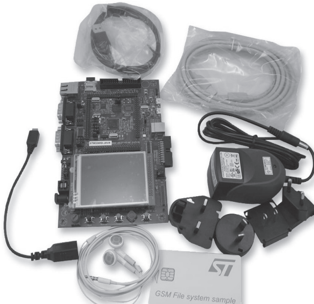
Рис. 1.4. Внешний вид стартового набора «STM3240G-JAVA» [1-9]
