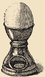
Приборъ для опредѣленія свѣжести яицъ.
