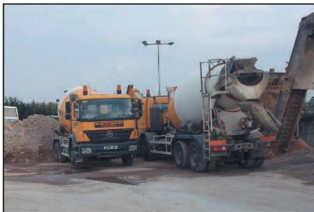
**Рис. 13** Автомобили, доставляющие готовую бетонную смесь.
