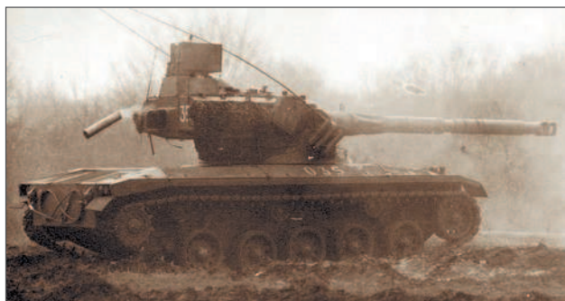
Танк SK105 австрийской армии на учениях. На снимке хорошо виден выброс гильзы после выстрела
