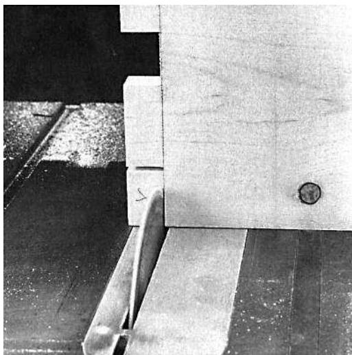
**Завершите вырезание шипов, повернув ножку на 90° и подняв диск на нужную высоту по ширине заплечика и срезав лишний материал одним проходом пилы.**
