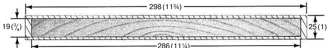
Относительно плоскую доску примерного размера с толщиной 25 мм (1 дюйм) можно превратить в плоскую, прямоугольную и прямую доску толщиной 19 мм.
