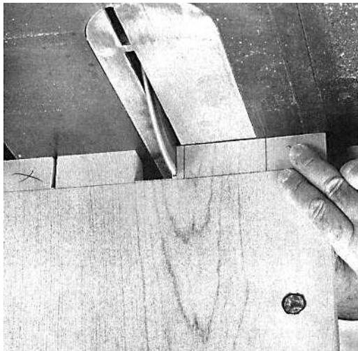
**Циркулярка быстро вырезает шипы. Высоту пильного диска установите равную толщине материала. Поставьте ножку на торец и подавайте с помощью углового упора. Сделайте пропилы по обе стороны разметки каждого шипа. Затем выберите отход между двумя шипами дополнительными пропилами.**
