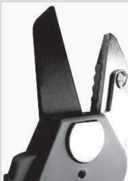
Во втором случае лезвие прямое и при резании упирается в торец противоположной пластины, как бы обрубая ветку. Конструкция этих секаторов исключает проблему «заклинивания», свойственную прочим секаторам. Однако у них имеются неустранимые недостатки.
