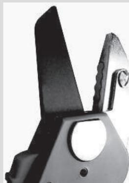
Во втором случае лезвие прямое и при резании упирается в торец противоположной пластины, как бы обрубая ветку. Конструкция этих секаторов исключает проблему «заклинивания», свойственную прочим секаторам. Однако у них имеются неустраняемые недостатки.
