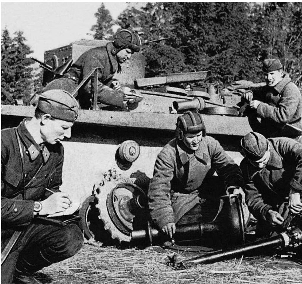
Ремонт танка Т-37 в полевых условиях. Западный фронт, предположительно 107-я мотострелковая дивизия, сентябрь 1941 года. Красноармейцы разбирают дифференциал от ГАЗ-АА – танк Т-37 создавался с использованием автомобильных агрегатов.
