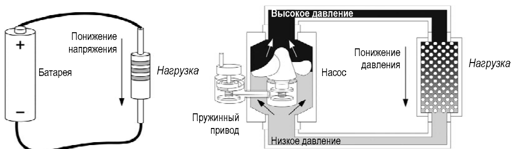
РИС. 2.11. Объяснение электрического тока аналогией с течением воды
