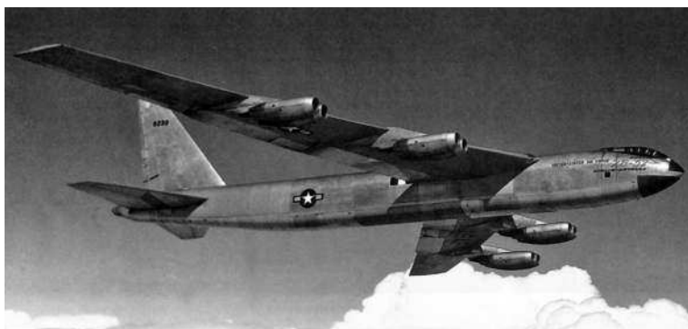
Без подкрыльевых баков XB-52 был очень «чистым» самолетом, однако их наличие позволяло уменьшить изгибающий момент, действующий на крыло, и избежать флаттера на некоторых режимах.
