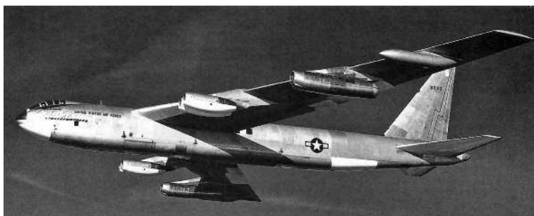
XB-52 показан в конце карьеры, когда он летал в качестве летающей лаборатории для двигателей Пратт-Уитни J75. Двигатели J75 установлены в одиночных гондолах на крайних пилонах. Подкрыльевые баки остались на месте.
