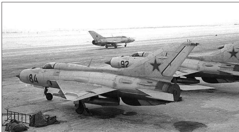
Истребители МиГ-21ПФМ на аэродроме. Из-за малого запаса горючего во баках самолета большинство полетов выполнялось с использованием подвесного топливного бака
