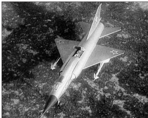
Модель одного из первых вариантов «фронтового истребителя-перехватчика МиГ-23», оснащенного двумя подъемными двигателями в фюзеляже
