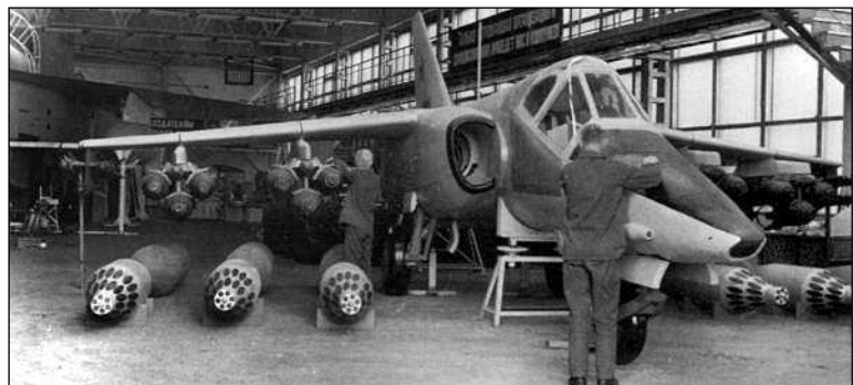
Доработанный макет легкого самолета-штурмовика (ЛСШ) с выкладкой вариантов вооружения
