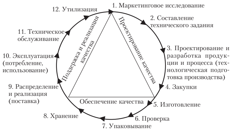
Рис. В.3. Процессы жизненного цикла продукции и «треугольник качества»
