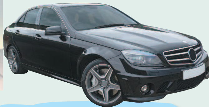
↑ Легковой автомобиль. Предназначен для перевозки пассажиров (не более 8 мест, не включая водителя) и багажа. Масса такой машины не превышает 3,5 т. Может выпускаться как с закрытым кузовом, так и с кузовом, верх которого отсутствует либо убирается.
