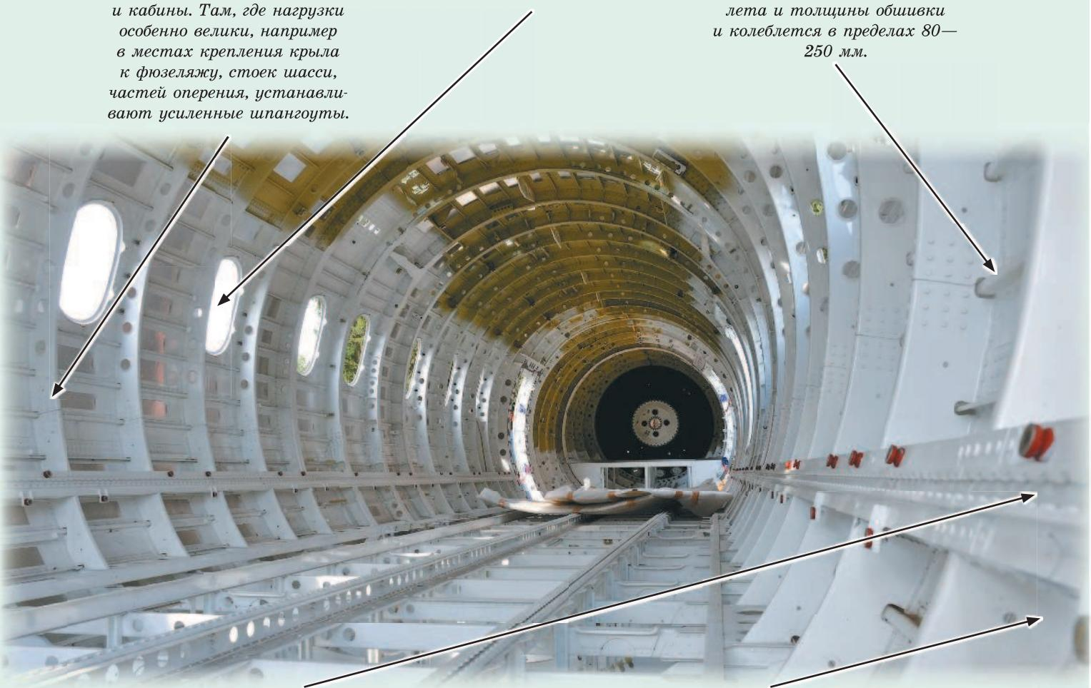
**Лонжерон.** Это основная балка, которая пролегает вдоль всего фюзеляжа и, работая на сжатие—растяжение, воспринимает силы, изгибающие фюзеляж. Конструктивно лонжероны представляют собой гнутые или прессованные металлические профили различных сечений, а на самолетах большой грузоподъемности их даже склеивают из нескольких профилей.
