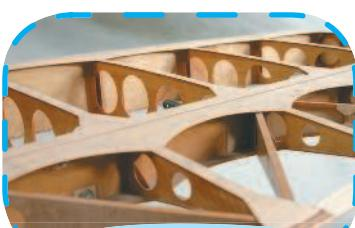
↑ Некоторые модели самолетов должны иметь плоскости крыла повышенной прочности. Это достигается за счет использования специальных элементов — подкосов, устанавливаемых между лонжеронами и нервюрами. Они образуют внутри крыла упорядоченную жесткую систему, состоящую из множества небольших треугольников.
