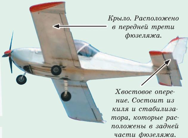
Киль. Расположен в задней части фюзеляжа и имеет руль направления.
