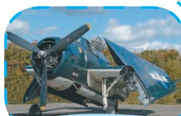
↑ В зависимости от конструкции самолета плоскости крыла могут быть съемными или жесткозакрепленными. Съемные плоскости позволяют беспрепятственно транспортировать самолет наземным или морским путем. Кроме того, они могут быть складными, что позволяет значительно сократить площадь, необходимую для хранения самолета, например в ангаре авианосца.
