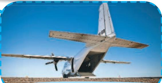
↑ Для размещения крупногабаритных грузов многие транспортные (грузовые) самолеты имеют в задней части фюзеляжа дверь с погрузочной платформой.
