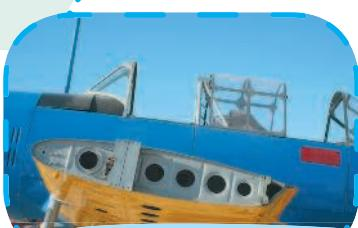
↑ В разрезе крыла хорошо видны все элементы его силового набора: лонжероны, стрингеры и нервюра.
