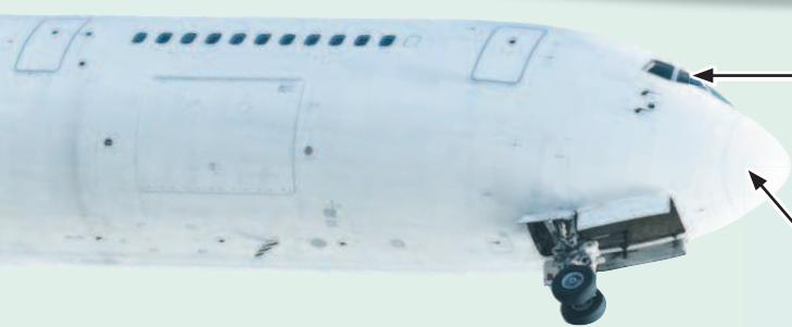
Кабина экипажа. Для улучшения обзора ее несколько выносят вперед. Однако при этом увеличивается волновое сопротивление фюзеляжа. Поэтому на некоторых сверхзвуковых самолетах кабину закрывают обтекателем, а для улучшения обзора при посадке и взлете носовую часть делают отклоняющейся вниз.
