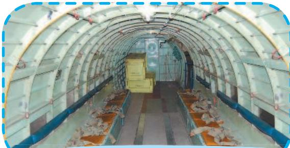
↑ В грузовых отсеках военно-транспортных самолетов доставляют различные военные грузы, технику и вооружение. Кроме того, они могут быть оборудованы местами для перевозки личного состава военно-десантных войск.
