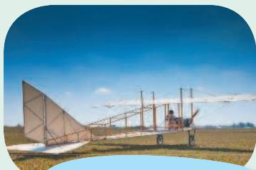
↑ Фюзеляжи первых самолетов обычно состояли из четырех длинных брусьев — лонжеронов. Они скреплялись между собой вертикальными и горизонтальными стойками и туго натянутыми крест-накрест стальными тросами. Лонжероны и стойки вначале делали из дерева, а позже — из стальных труб. В передней части фюзеляжа находилась моторная рама, на которой был закреплен мотор. Ее делали очень прочной и изготавливали из стальных труб, так как иначе от вибраций мотора она могла развалиться.
