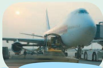
↑ Круглая форма обеспечивает наименьшую площадь поверхности при заданном объеме и, следовательно, минимальное сопротивление. Однако с точки зрения размещения грузов и более рационального использования внутренних объемов фюзеляжа предпочтительнее использование овальной формы поперечного сечения. Поэтому именно ее довольно часто применяют на пассажирских и транспортных самолетах.
