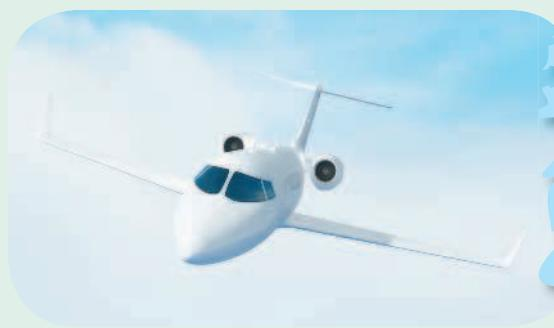
← Изучая различные типы самолетов, можно заметить, что некоторые модели имеют загнутые вверх кончики плоскостей крыла. Эти элементы называются законцовками крыла и служат для плавного огибания вихревыми потоками воздуха конца крыла и тем самым увеличивают подъемную силу на конце крыла. Кроме того, законцовки позволяют увеличить длину крыла, почти не изменяя при этом его размах.
