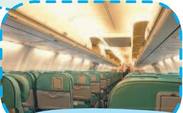
↑ Устройство пассажирского салона. Обычно кресла устанавливают в два ряда с проходом между ними, но существуют и широкофюзеляжные самолеты, в салоне которых установлены три ряда кресел с двумя проходами между ними.
