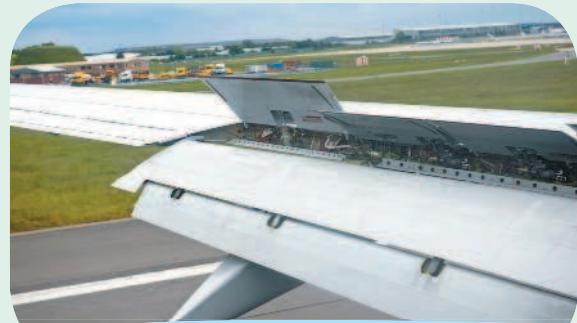
↑ Самолет снижает скорость во время посадки — тормозной щиток поднят.
