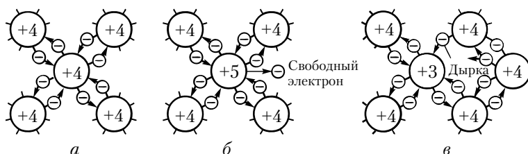
Рис. 1.2. Кристаллическая структура чистого полупроводника ( а ), полупроводника с донорной ( б ) и акцепторной ( в ) примесью
