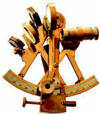
Секстант, прибор для измерения высоты светил над горизонтом
