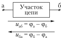
Условимся разность потенциалов u_{ab} = \varphi_a - \varphi_b на схеме обозначать стрелкой, направленной от точки «а» к точке «б» (рис. 1.20). Стрелке противоположного направления будет соответствовать разность потенциалов \varphi_b - \varphi_a , обозначаемая как u_{ba} . Таким образом, u_{ab} = -u_{ba} (см. рис. 1.19).
