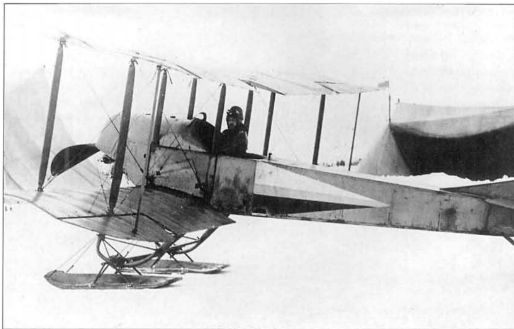
Фиг. 3. С-16 No. 155 с измененным капотом двигателя в ЭВК (архив НММ Н.Е. Жуковского)
