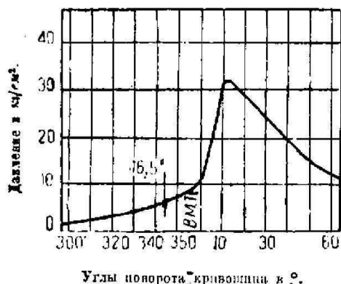
Фиг. 6. Максимальное давление — 32,7 \text{ кг/см}^2 ; углы поворота кривошипа в градусах; скорость поднятия давления 2,42 \text{ кг/см}^2 на 1^\circ поворота кривошипа. Опережение зажигания 16,5^\circ .
