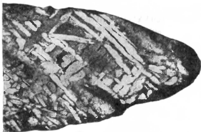
Видманштеттеновы фигуры на полированной поверхности метеорита Чебанкол
