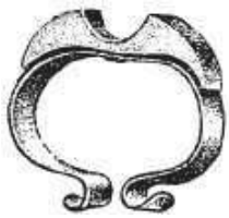
Рисунок 5. Съёмный прицел, надеваемый на казённую часть стволов ружья для повышения его боя и облегчения прицеливания
