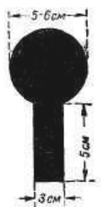
Рисунок 3. Конфигурация и размеры чёрного яблока мишени для проверки боя ружья
