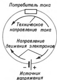
Рис. 2. Направление движения электронов и направление тока, принятое в технике
