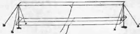
Рис. 3. Антенна маломощной полевой радиостанции.
