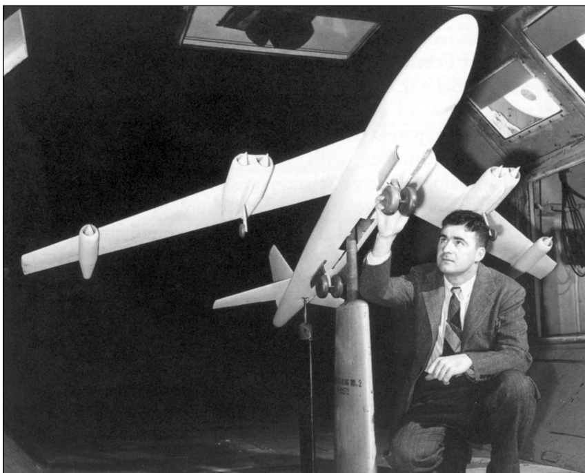
Инженер проверяет установку шасси на модели для аэродинамических исследований. 25 февраля 1952 г. Фото: «Боинг».
