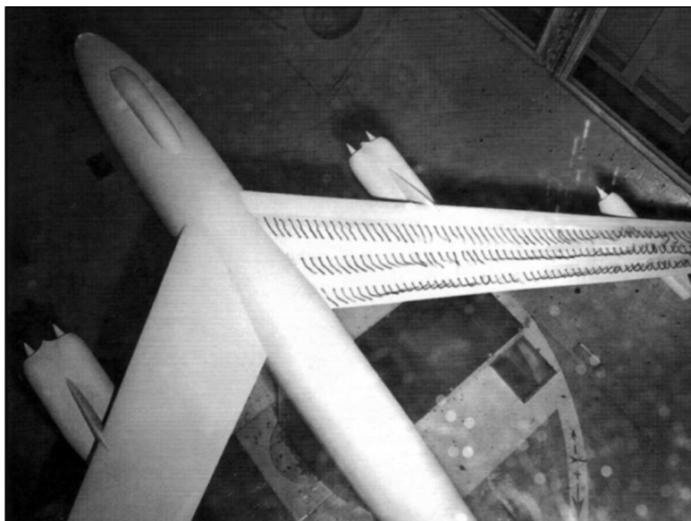
На верхней поверхности крыла были нанесены ленточки для исследования обтекания во время трубных продувок. На снимке модель, в масштабе 1:20. Некоторые ленточки завернулись в обратную сторону. Это значит, что в этой зоне наступил срыв потока. Фото: «Боинг».
