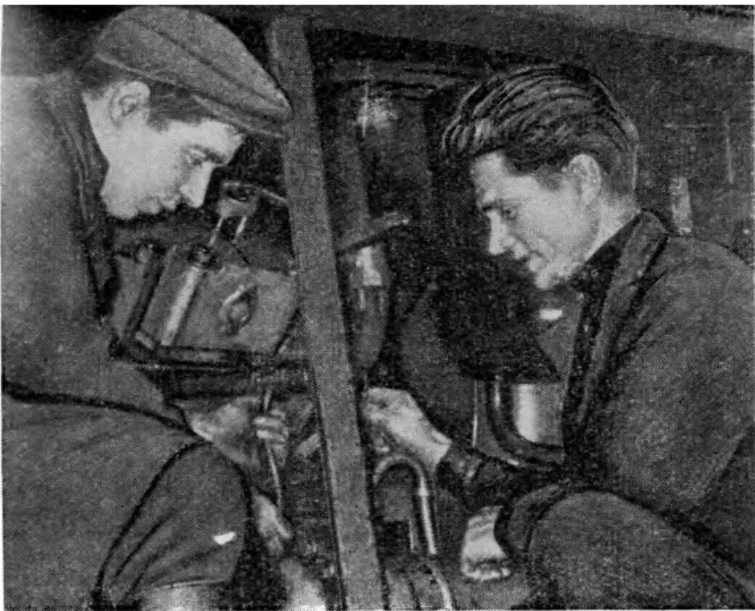
Наиболее активный рационализатор коммунист Илья Просветов (с п р а в а) и комсомолец Анатолий Пеньков устанавливают генератор освещения на тепловозе «МГ-1».
