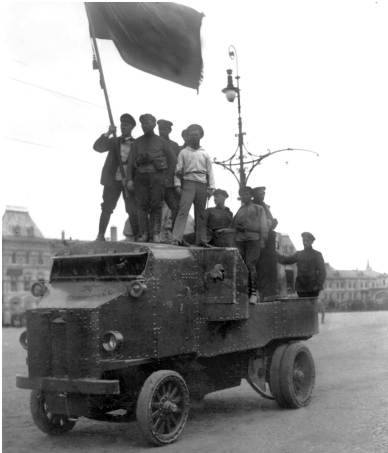
Празднование Дня всеобща в Москве, май 1918 года. На фото броневик «Гарфорд» с названием «Замоскворечье», принадлежавший красногвардейскому отряду этого района. Судя по усиленным колесам с дополнительными болтами и звуковому сигналу на крыше, машина из числа броневиков, изготовленных по заказу Морского ведомства для крепости Императора Петра Великого (РГАКФД).
