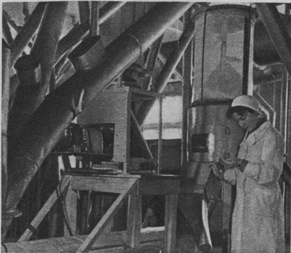
Установка для витаминизации муки на экспериментальной мельнице Всесоюзного научно-исследовательского института зерна. Такие установки уже действуют в ряде городов страны
