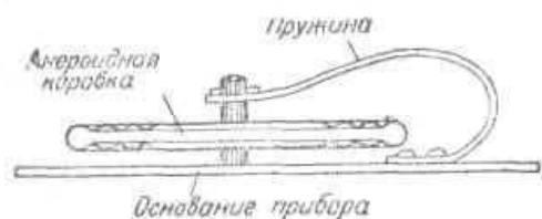
Рис. 8. Схема устройства aneroidной коробки с пружиной
