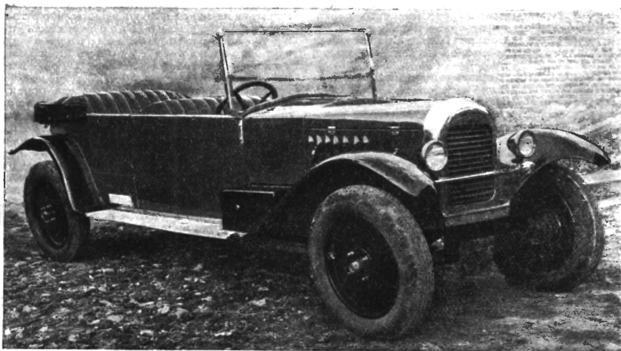
Легковая машина советской конструкции НАМИ 1. По типу близка к автомобилям Форда. При массовом производстве, благодаря простоте и оригинальности конструкции, может дать нужный нам тип легкого дешевого советского автомобиля
