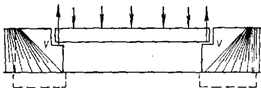
Рис. 6. Схема балочного моста
