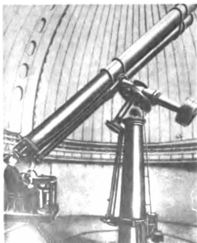
Рис. 6. Двойной рефрактор-астрограф Московского университета для рассматривания и фотографирования небесных светил.
